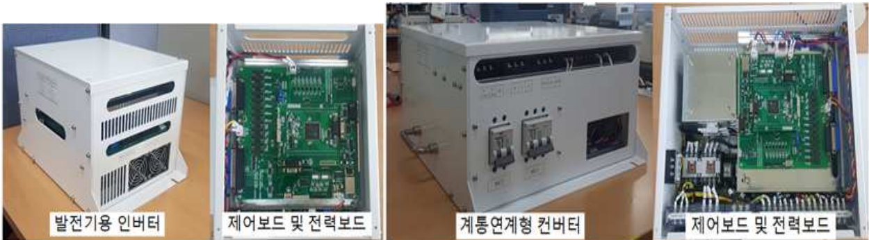
(a) 발전기용 인버터 & 제어보드 및 전력보드
